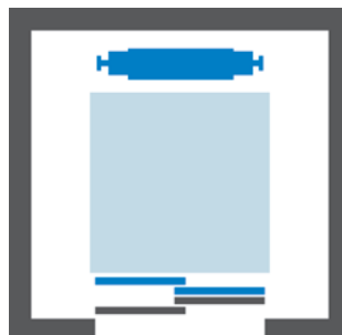
Ihre alte Kabine Seilauzüge haben in der Regel ein Gegengewicht, das einen nicht unerheblichen Teil des Schachtraumes einnimmt.
